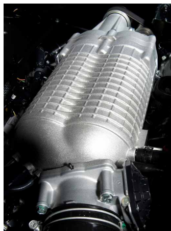
Siehe oben: Harrop HTV 1320 supercharger mit Eaton TVS™ technology
